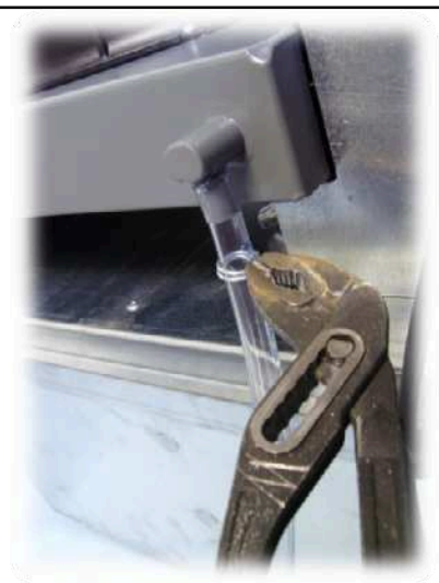
Pincer le collier pour l'ouvrir et le coulisser le long du tuyau
